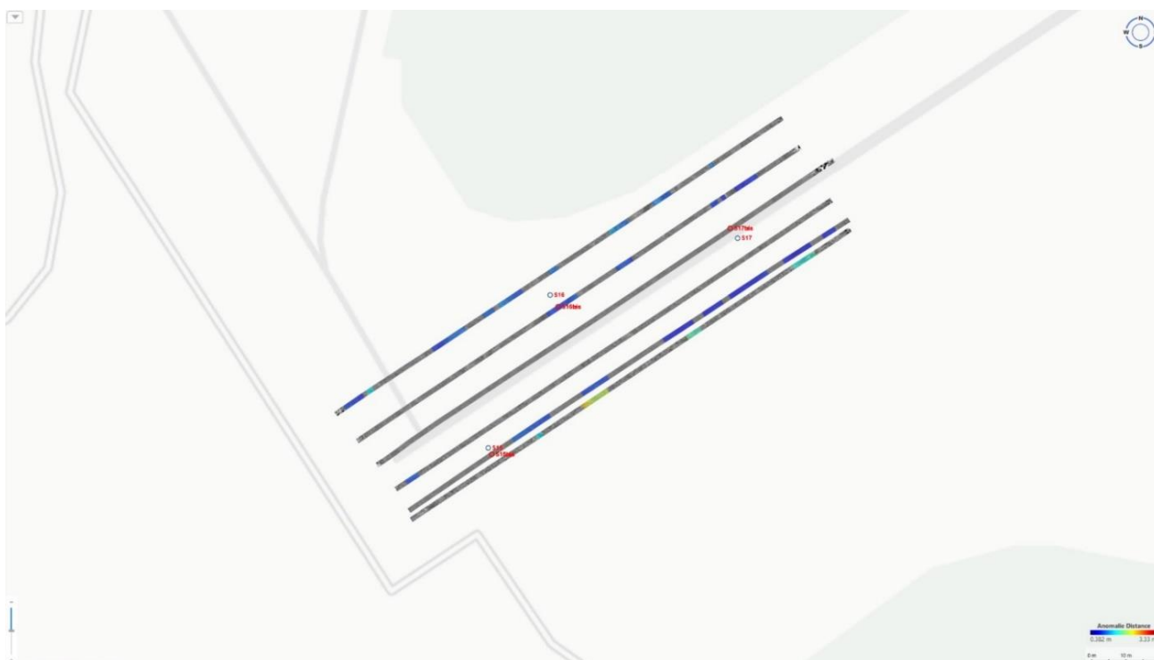
Figure 17 : SEUIL 6 - Variation de la profondeur des anomalies géoradar
