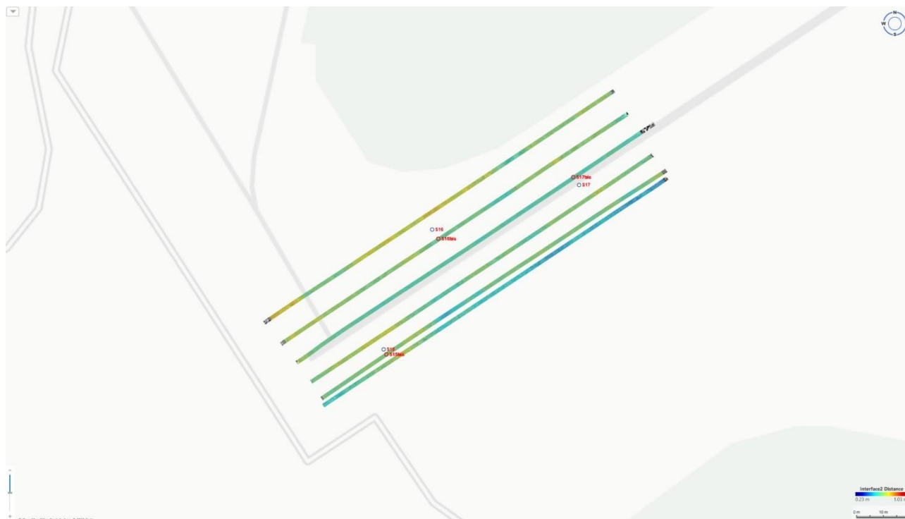
Figure 16 : SEUIL 6 - Variation de la profondeur de l'interface 2
